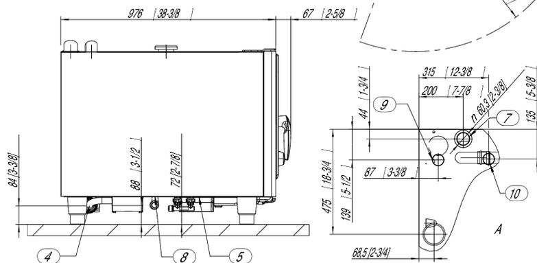
1. Gemeinsamer Wasserzulauf (Kaltwasser) 2. Wasserzulauf Kaltwasser 3. Wasserzulauf Weich- bzw. Warmwasser 4. Wasserablauf 5. Elektroanschluss 6. Potentialausgleich 7. Entlüftungsrohr DN 60 8. Gasanschluss 3/4" 9. Ablufrohr Gas (Dampf) 10. Ablufrohr Gas (Heißluft) Mindestabstand 50 mm Maße in mm (inch)
